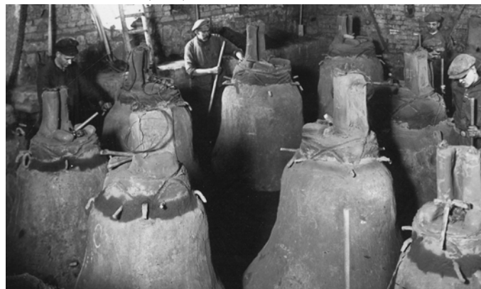
Vorbereiten der Glockenformen für den Guss
